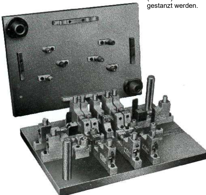
JOKA-Stanzeinheiten der Reihen H und Z in einem Säulengestell umrüstbar auf 2 Werkstückarten montiert. Bei diesen Werkstücken handelt es sich um vorgezogene Deckel und Böden, in die im gleichen Hub Löcher und Durchstellungen in alle vier Seitenflächen (horizontal) und in den Boden (vertikal) eingestanz werden.
